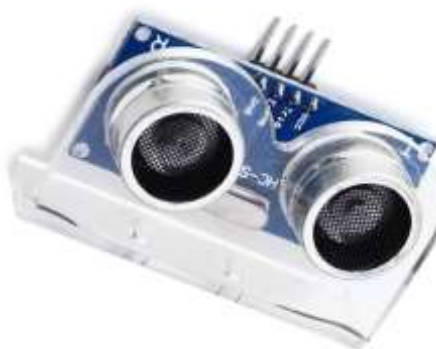
Εικ. 4 Τοποθέτηση αισθητήρα στη βάση στήριξης
